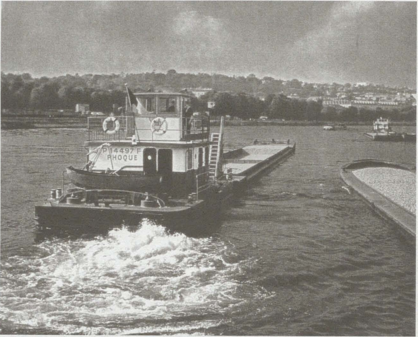
Le pousseur Phoque d'une puissance de 300 CV construit par les ateliers de la C.S.S. en navigation sur la Seine. Sa fonction est d'acheminer les barges de sable vers l'un des quatre pousseurs de 460 CV pour constituer un convoi, vers 1960. Coll. C.S.S.
